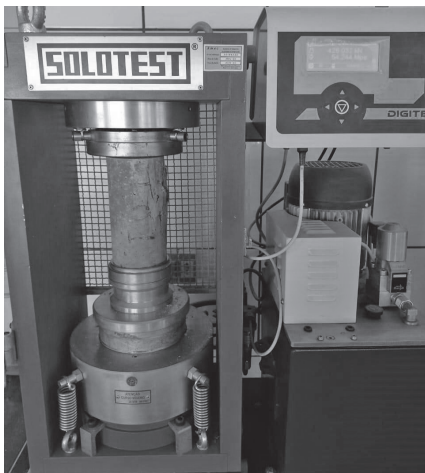
Figura 7 – Rompimento do corpo por compressão
