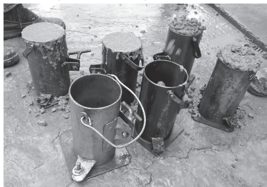
Figura 5 – Moldagem dos corpos
